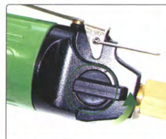
Regulador - Llave de paso de seguridad
