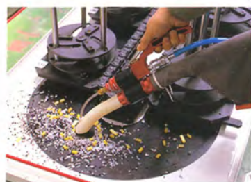
Eliminación de restos de cables en cadena de montaje
