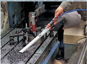
Limpieza de viruta en maquinas- herramientas
