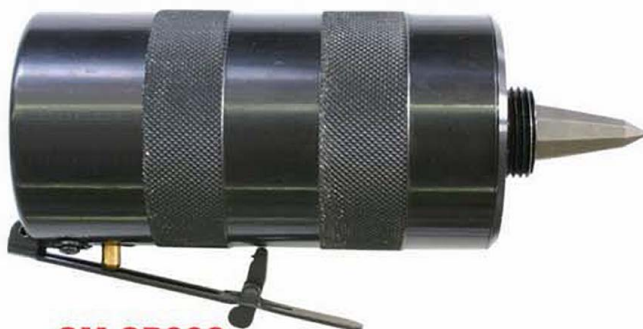
SM-SP008 Cuerpo pistón Longitud: 143 mm Diámetro: 74 mm Peso: 1.120 g Empuje a 5,5 Bar: 22.250 N
