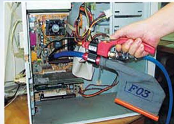
Aspiración de polvo fino en ordenadores y cuadros eléctricos
